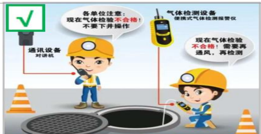
有限空间作业前气体检测
