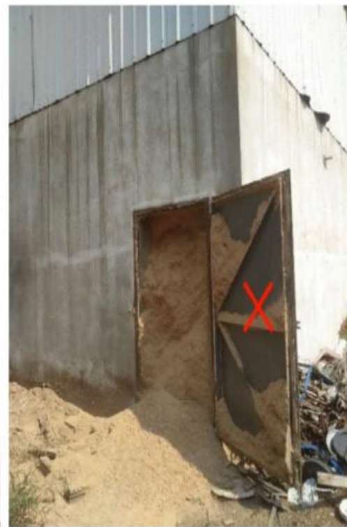
木质粉尘干式除尘系统未设置锁气卸灰装置
