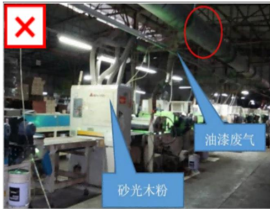
可燃粉尘与可燃气体混用一套除尘器系统
